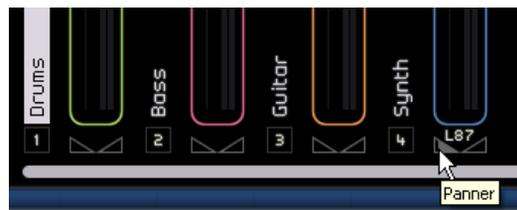
⇒ Si necesita volver a dejar el panner en posición central, pulse [Ctrl]/[Comando]-clic directamente en el área del panner.
