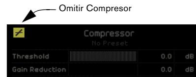
El deslizador Threshold determina la cantidad de compresión que será aplicada a la señal, lo que configura un nivel de umbral. Cuando la señal sobrepasa este nivel, el compresor reduce el nivel de la señal. O, en otras palabras: cuanto más a la derecha lo arrastre, más compresión obtendrá. Gain reduction refleja la cantidad de ganancia o de volumen que se atenúa.
