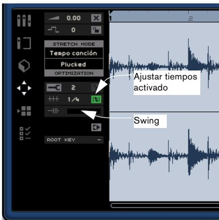
Swing aparece cuando se ha activado “Ajustar tiempos”. Swing le permite añadir una sensación más natural al evento de audio. Haga clic y arrastre el deslizador a la izquierda o derecha para añadir o suprimir el swing. El efecto de usar swing depende del valor “Cuantizar”. Si, por ejemplo, ha configurado corcheas, sólo se verán afectadas las corcheas al cambiar la cantidad de swing.
