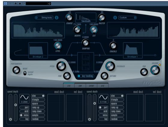
El método de síntesis usado por el sintetizador Mystic se basa en tres filtros en peine configurados en paralelo con realimentación. Un filtro en peine es un filtro con varias “hendiduras” en su respuesta en frecuencia, con la frecuencia de sus hendiduras relacionada armónicamente con la frecuencia de la hendidura fundamental (más grave).
