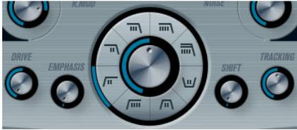
El círculo central contiene los parámetros del filtro. El dial central ajusta el parámetro de frecuencia de corte y el anillo exterior el tipo de filtro:
