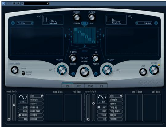
La síntesis en este sintetizador está basada en torno a un “filtro espectral”, que permite especificar la respuesta en frecuencia dibujando su contorno en el visor de espectro. Simplificando ligeramente, el enrutado de la señal es el siguiente:
